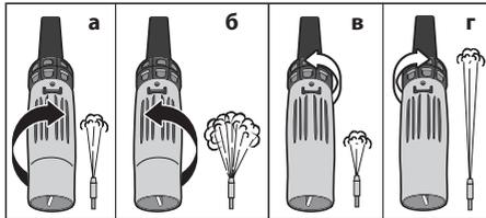
При необходимости обработки изделия или поверхности моющим средством, снимите (кроме АВД-100...135) крышку **10** бачка и, соблюдая рекомендованную производителем концентрацию, заправьте емкость моющим раствором. Установите струю низкого давления, нанесите моющее средство на обрабатываемую поверхность и оставьте подействовать на 1-2 минуты, не допуская его высыхания. Вращая переднюю часть насадки (рис.а и рис.б) регулируйте количество подаваемого моющего средства.
