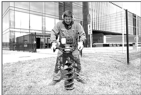
Рис. 8 Положение тела оператора при работе мотобуром
