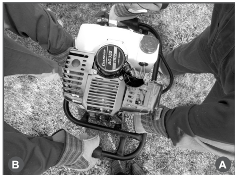
Рис.10 Положение рук при работе вдвоем
