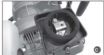
Рис. 11 Обслуживание воздушного фильтра
