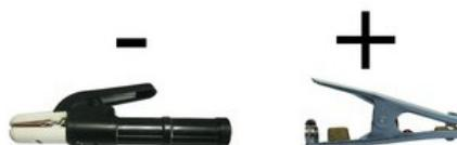
4. Вставьте вилку в сетевую розетку, вставьте электрод в ЭД, закрепите струбцину (КЗ) на заготовке, включите питание.
