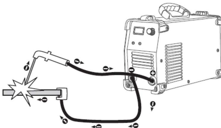
3. Используйте прямую и обратную полярность подключения кабеля в зависимости от указаний производителя электродов и в соответствии с процессом сварки детали. Неправильное выбор подключения вызовет нестабильность дуги, большее разбрзгивание и прилипание электрода.
