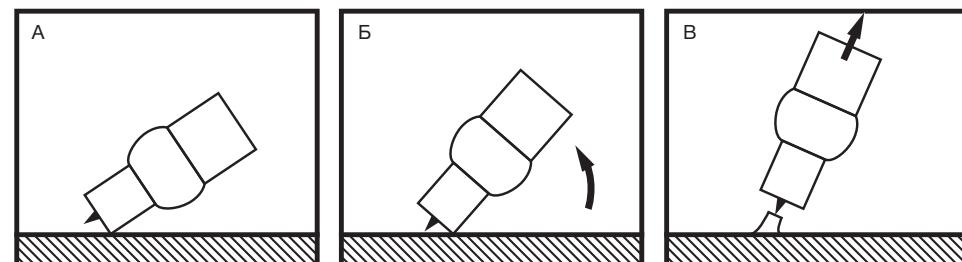
А. Поставьте керамическое согло горелки на изделие, не касаясь при этом вольфрамом детали. Держите расстояние 2-3 мм. Откройте вентиль горелки.
